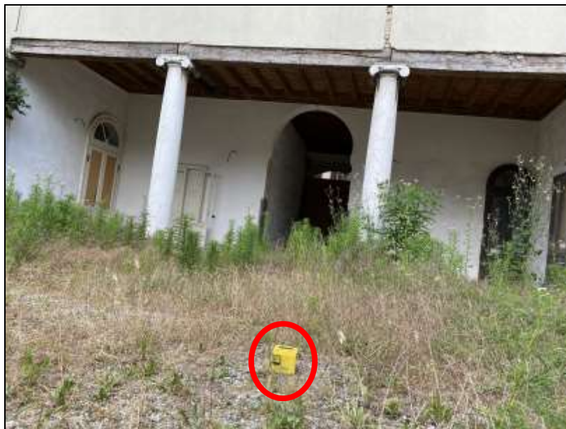
Figura 6: esecuzione della misura di sismica passiva nel sito di Crema, via Matteotti (nel circolo rosso il tromografo digitale)
