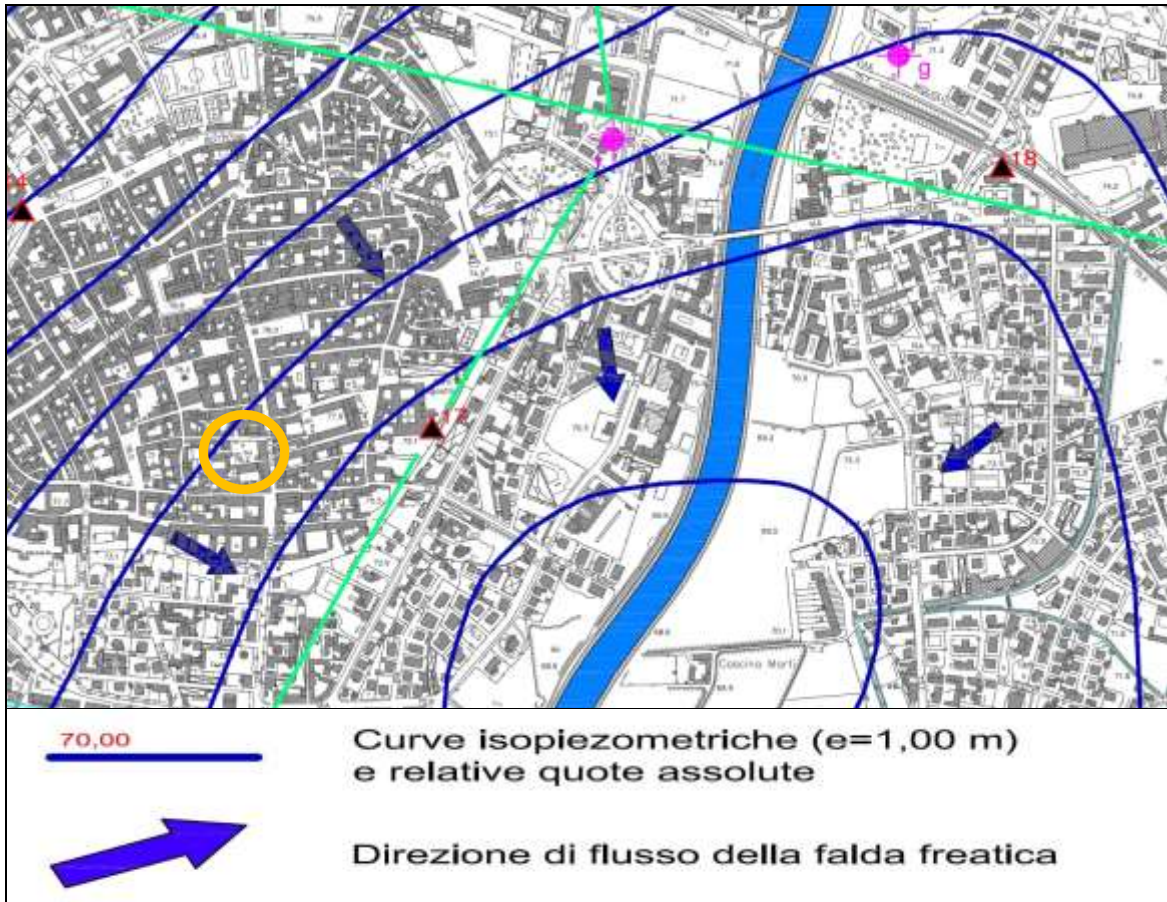
Figura 4: stralcio della Carta Idrogeologica Tavola 4B allegata allo Studio Geologico del territorio comunale di Crema (ex L.R. 12/2005). In giallo la zona di intervento, interessata dal passaggio dell'isopiezia 69 m s.l.m., che riferite al p.c. posto a 77,5 m determinano una soggiacenza di 8,5 m
