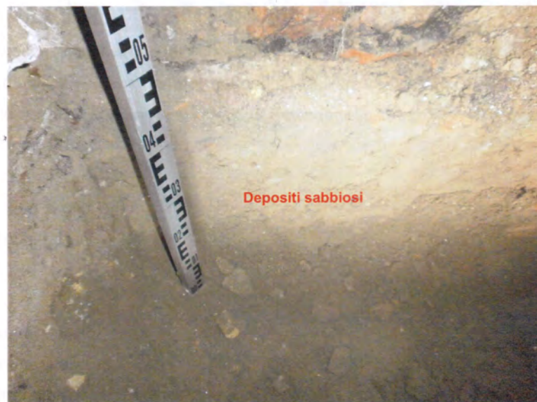
Fig. 9 – Sondaggio T3. Sono evidenti i depositi sabbiosi al di sotto del magrone e delle fondazioni di muratura.
