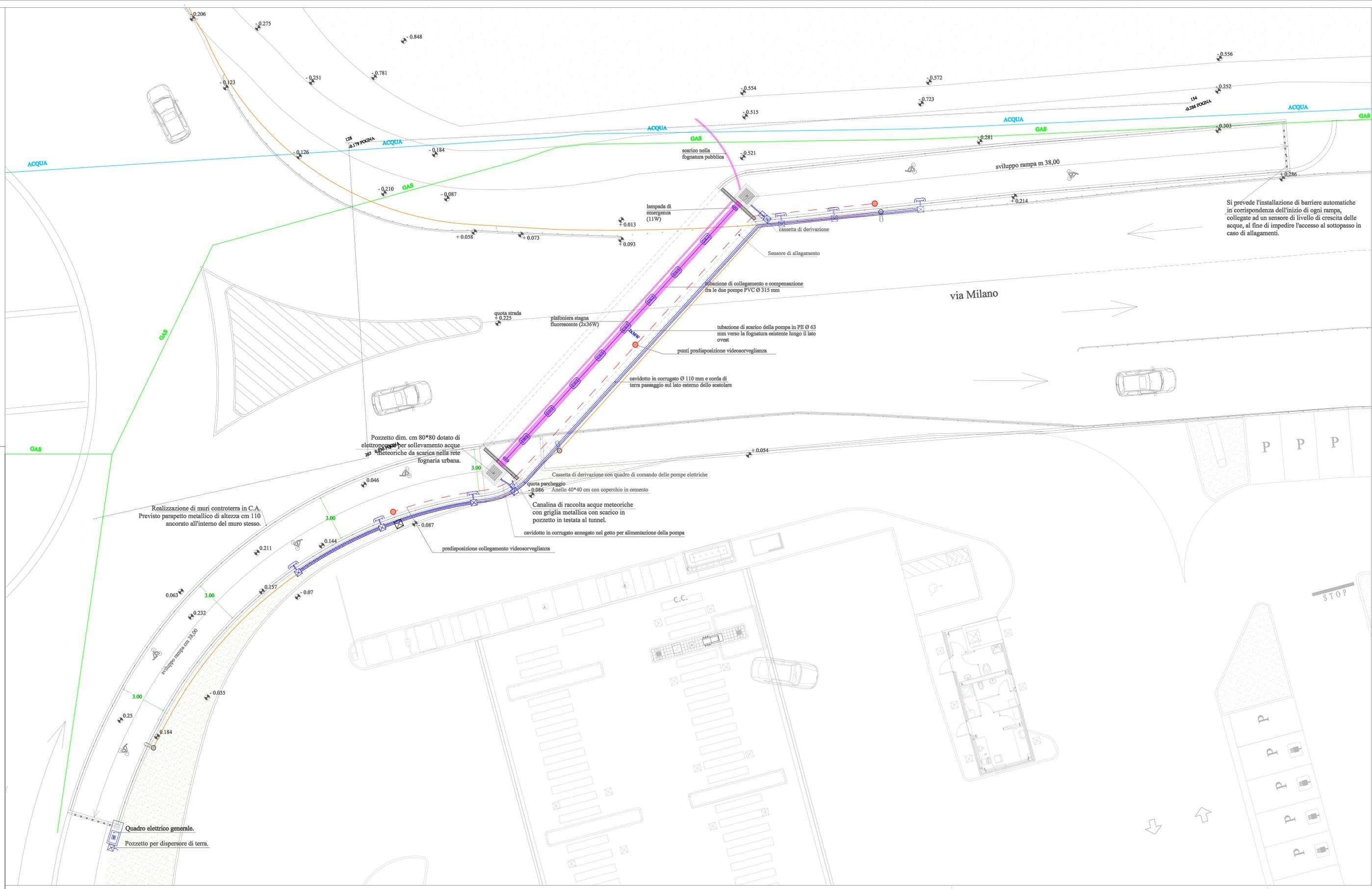
Si prevede l'installazione di barriere automatiche in corrispondenza dell'inizio di ogni rampa, collegate ad un sensore di livello di crescita delle acque, al fine di impedire l'accesso al sottopasso in caso di allagamenti.
