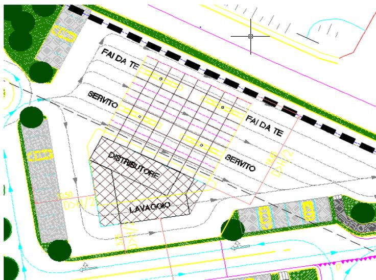
Figura 4: Distributore di benzina con autolavaggio
