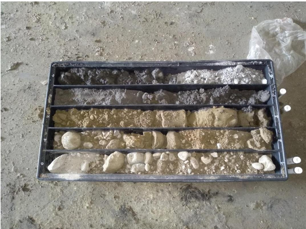
*Figura 6: sondaggio S3 da 0 a 5 m*
