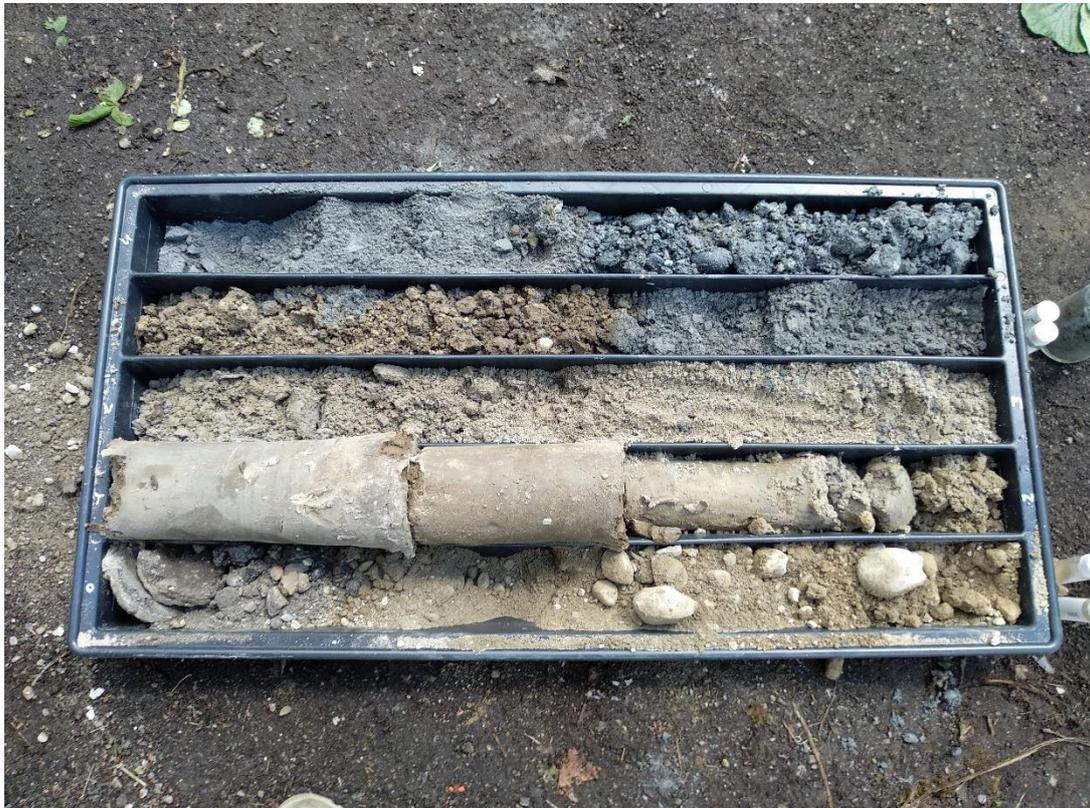
*Figura 4: sondaggio S2 da 0 a 5 m*
