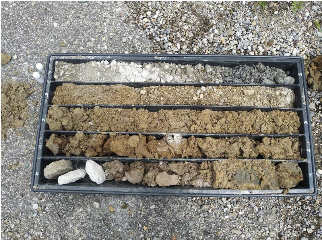
*Figura 10: sondaggio S5 da 0 a 5 m*
