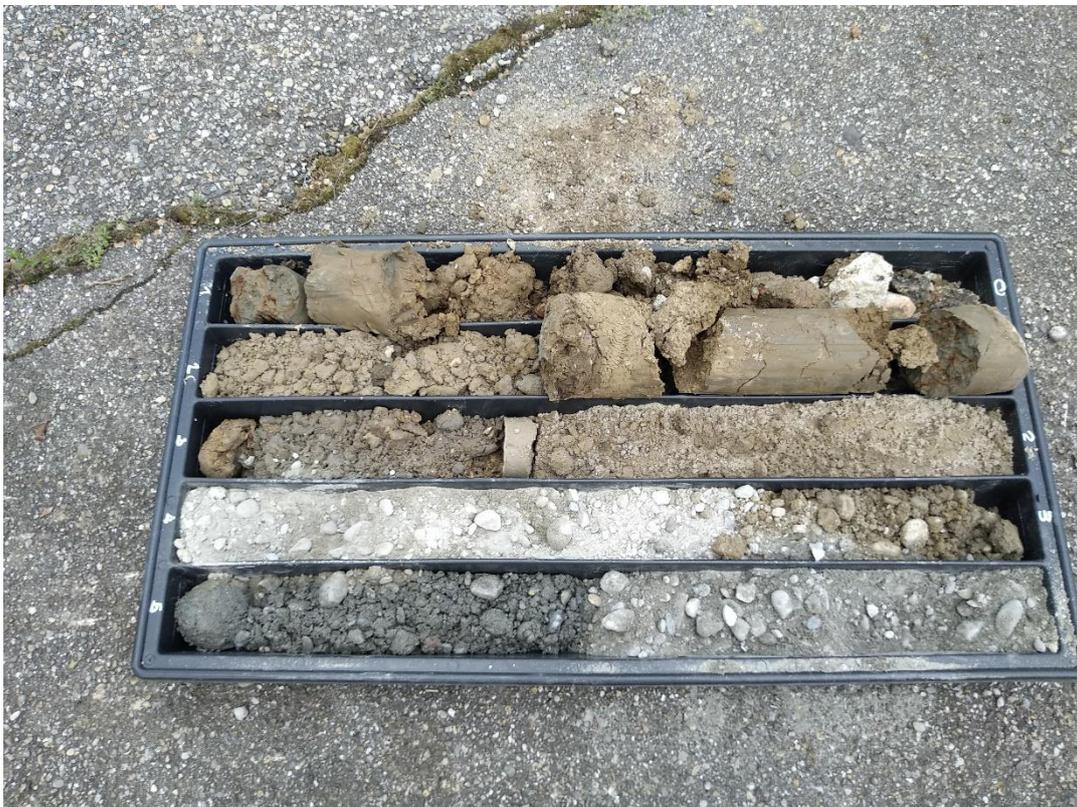
*Figura 8: sondaggio S4 da 0 a 5 m*
