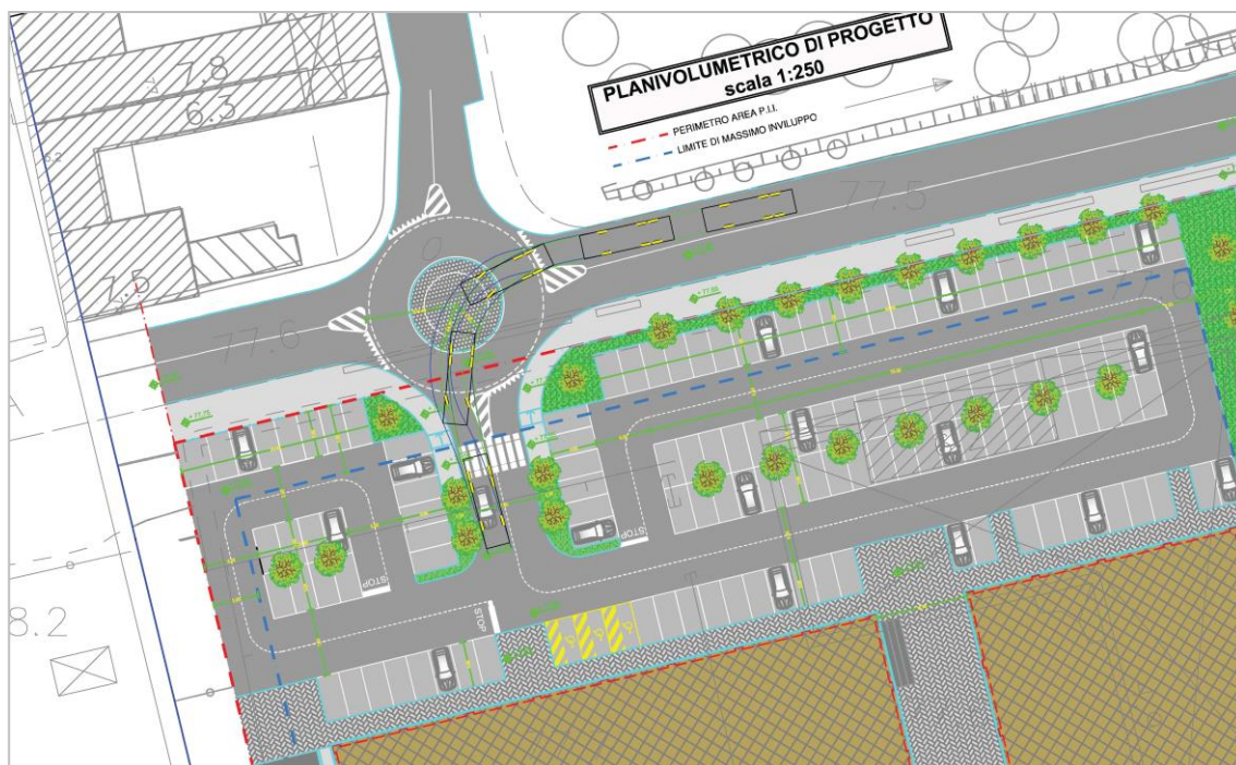
Figura 6.7.1 – Modello dinamico: simulazione dell'entrata con svolta a sinistra del mezzo lungo 10 m (Isola centrale completamente sormontabile)
