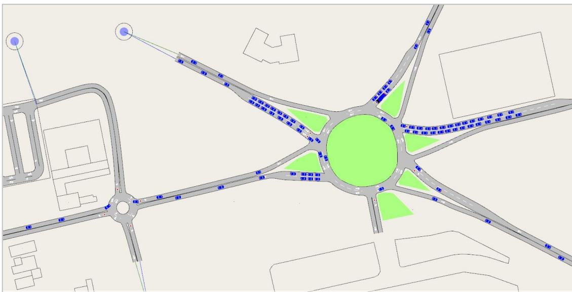
Figura 6.6.7 – Modello dinamico: Output grafico tipo delle code
