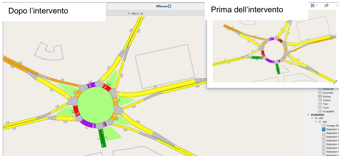
Figura 6.6.6 – Modello dinamico: simulazione dei F/C (Rapporti Flusso/Capacità) nell'ora di punta del pomeriggio prima e dopo la realizzazione del progetto commerciale
