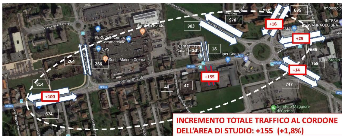
Figura 6.6.1 – I flussi di traffico totali (esistenti+generati) nell'ora di punta del pomeriggio: effetti sul Cordone del sistema viario dell'Area di Studio
